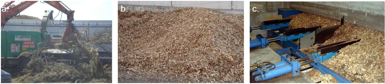
Fig. 7: Operazioni sulla piazzola, a. cippatura, b. stoccaggio, c. movimentazione del cippato.
